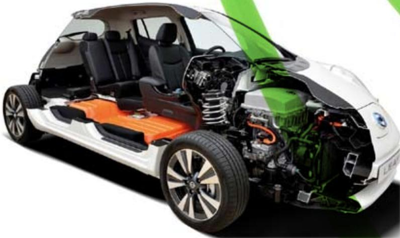
Los cables de alimentación son cables de alta tensión de gran sección para soportar el elevado paso de corriente que por ellos se transmite. Conecta por un lado la batería HV con el conjunto inversor, y por otro lado, al conjunto inversor con MG1, MG2 y el compresor del aire acondicionado.
