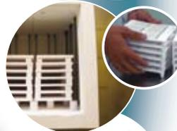
Corte y horneado del conjunto final para obtener el elemento sensor cerámico.
