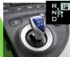
**El conjunto consta de dos sensores de posición de tecnología Hall IC**, sensor de selección y sensor de cambio, con lo que la ECU HV detecta la posición de la palanca del cambio (R, N, D y B).
