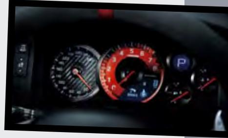
Otra de las funcionalidades relacionadas con la información del vehículo es el sistema multi-función, que permite al conductor elegir la información mostrada de los diferentes parámetros del coche (entre ellos la temperatura del refrigerante, la temperatura del aceite del motor, la presión de aceite, la temperatura del aceite del cambio o la presión de sobrealimentación del turbocompresor, entre otros). Las nuevas levas para el cambio se han montado ahora directamente
