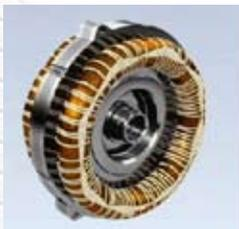
**El motor generador MG1**, tiene unido su rotor al engranaje planetario del tren epicicloidal del transeje, cumpliendo las siguientes funciones:
