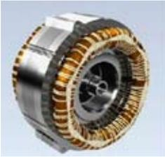
**El motor generador MG2**, tiene unido su rotor a la corona del tren epicicloidal del transeje, además de a las ruedas motrices, a través de grupo reductor y el diferencial. Cumple los siguientes cometidos:
